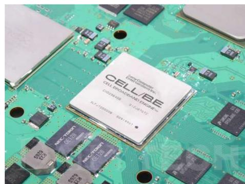
Figura 68 – Processador CELL
