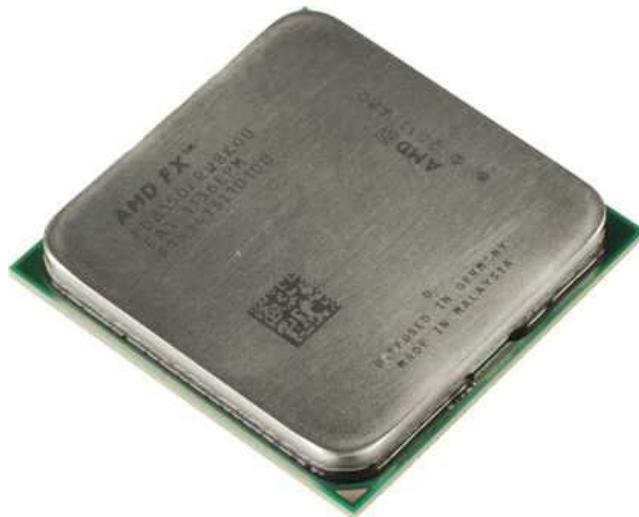
Figura 59 – Processador AMD FX
