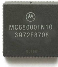
Figura 24– Processador Motorola 68000
