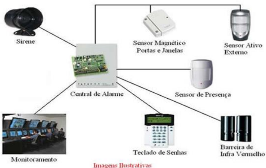
Figura 5 – Exemplo de um sistema de alarmes e suas conexões
