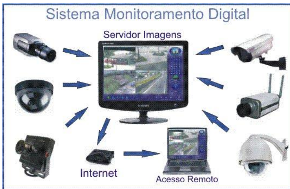
Figura 2 – Exemplo de sistema de câmeras com monitoramento digital
