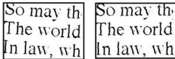
Figura 18 - Antes e depois da correção de enviesamento.
