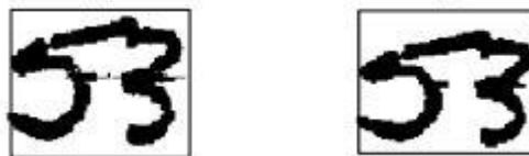
Figura 14 - Aplicação de filtro em uma imagem escaneada. A imagem processada (direita) possui contornos mais suaves e é mais suave que a original (esquerda).
